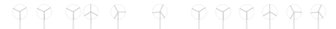
Effets visuels d'une implantation linéaire irrégulière (à gauche) et régulière (à droite)
